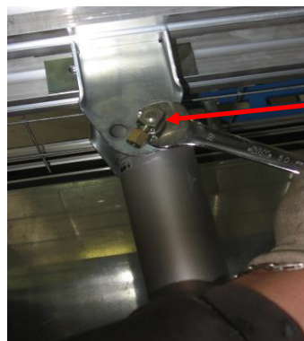
Banjo d'articulation et de raccordement du vérin (clé plate 19mm)
